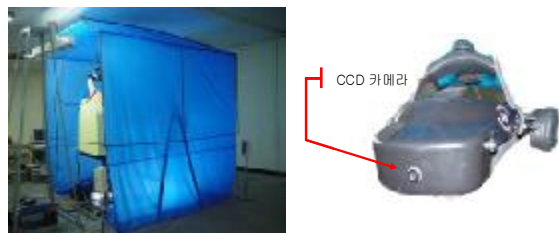
그림 8. 5 면 블루스크린(좌)과 CCD 부착 HMD(우)
